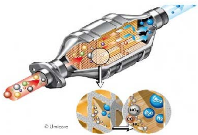
图 18: 一个典型的汽车催化剂系统
