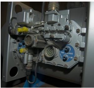
図 4. ジェミニ宇宙船のサービスモジュールに燃料電池が搭載された
