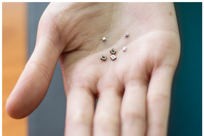
미세전자기계시스템(MEMS) 센서. 사진 제공: 보쉬(Bosch)
