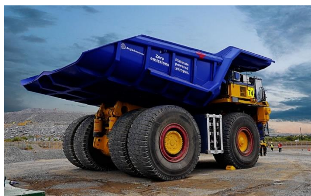
世界上最大的氢动力矿山运输卡车，设计用于日常采矿条件下运行。图片来源：英美资源集团。保留所有权利。
